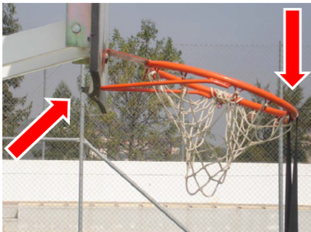
Foto 7 – Ensaio de rigidez interior/exterior. Neste ensaio percebe-se que o aro, em o painel não resistiram aos testes efetuados. Fonte: SPORT PARTNER – Distribuição e Fabrico de Equipamentos Esportivos
