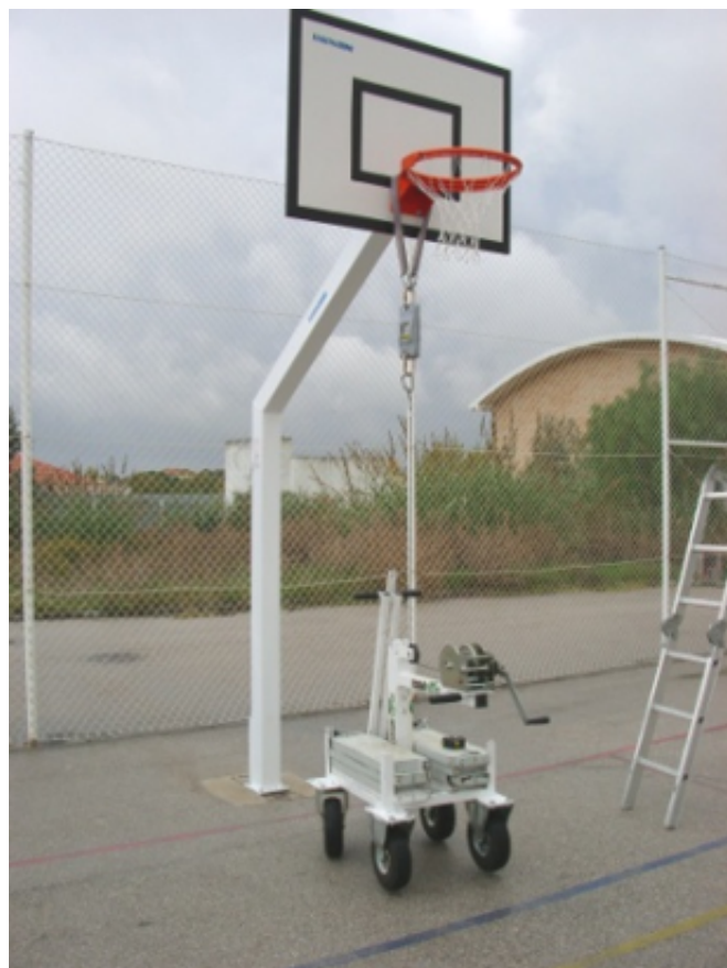
Foto 4 - Ensaio de estabilidade da estrutura do equipamento. Fonte: Eng. José Manuel Viegas - Lemnon Safe - Portugal
