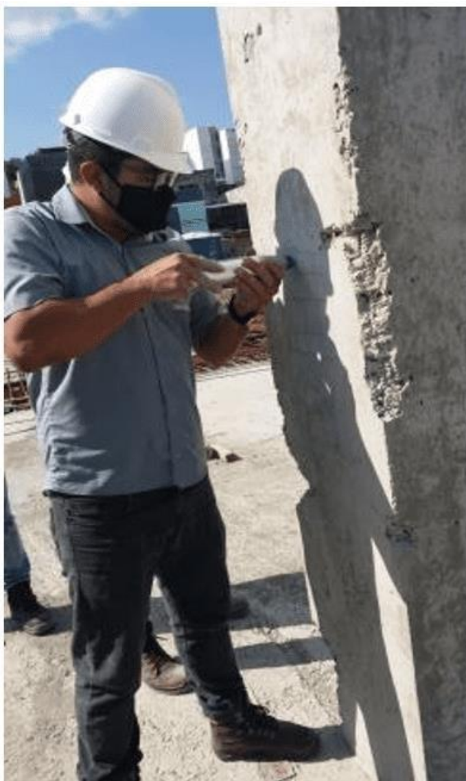
Figura 8 - Realização de ensaio de esclerometria no pilar do térreo
