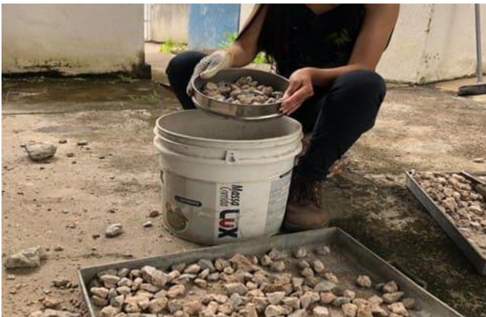
Figura 6 – Peneirando o material para usar apenas o passante na peneira de 19 mm.
