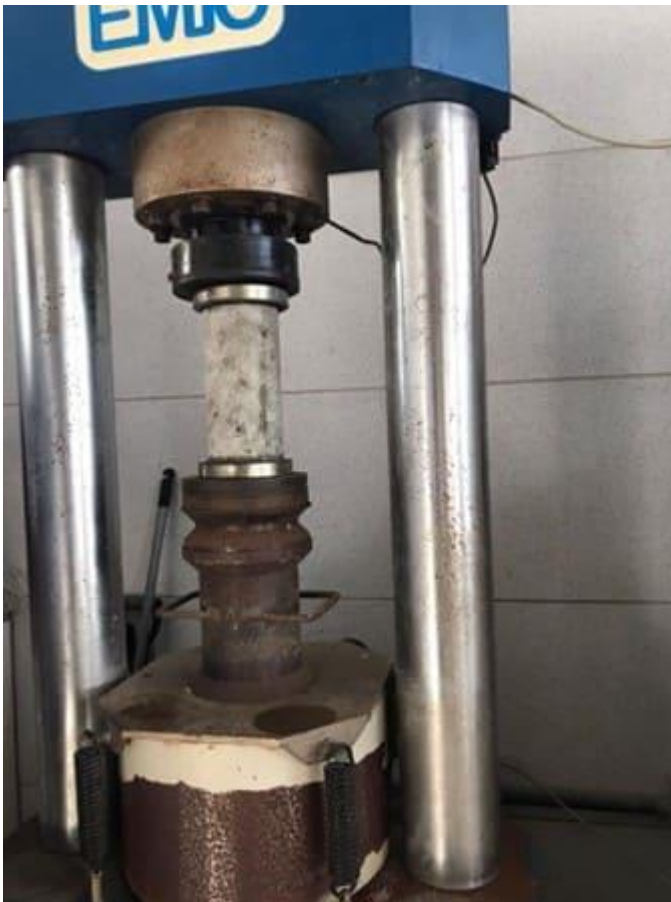
Figura 10 – Rompimento do corpo de prova na prensa mecânica
