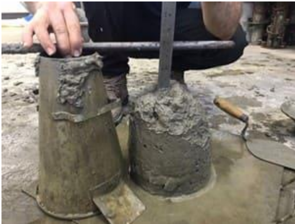
Figura 8 – Ensaio de abatimento de tronco de cone
