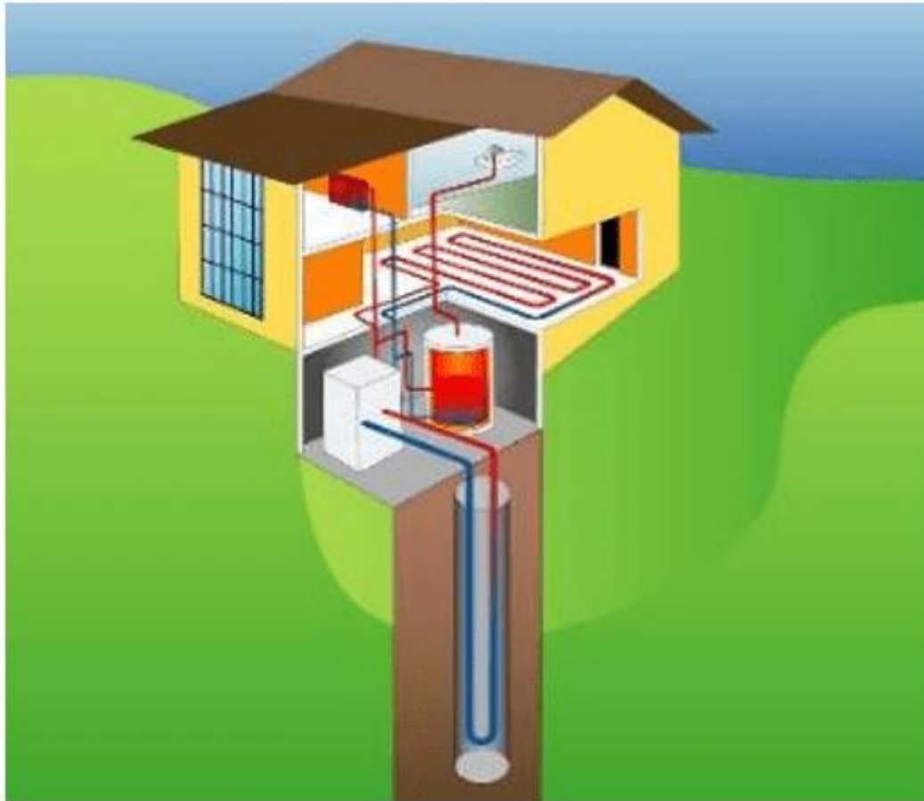
Figura 13 – Modelo de pozo geotérmico para calefacción doméstica o industrial
