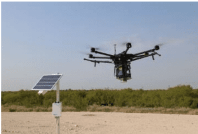
Figura 31 – Sistemas de monitoreo de metano, fijos y por drones
